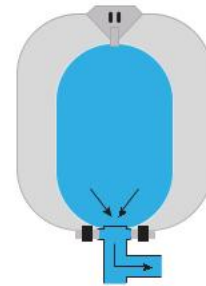
Çalışma Şartlarındaki Tank Görünümü
