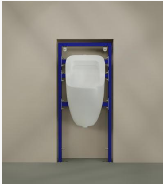
Pisuvar Konsolu 893-009 Yükseklik ayarlı, temiz su girişli ve pis su çıkışlı pisuvar konsolu.
